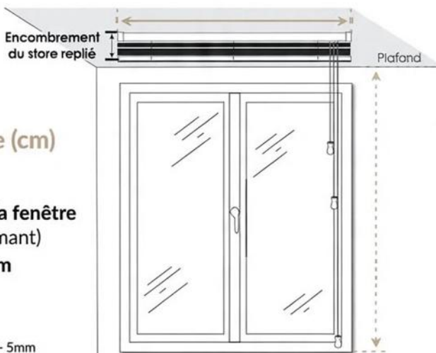
Schéma d'un store vénitien bois - lames 50mm
