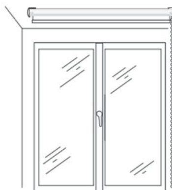
C - Au plafond
